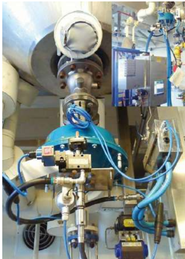
Dnový výpustný ventil SchuF s vestavěným IR čidlem, osazený na reaktoru, a připojený k monitorovacímu zařízení
